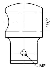
Применение: для трубы диаметром 19 мм
