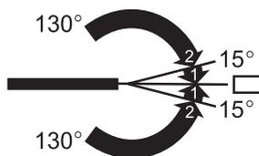
**1-й** диапазон имеет регулировку закрывания со 130° до 15°
