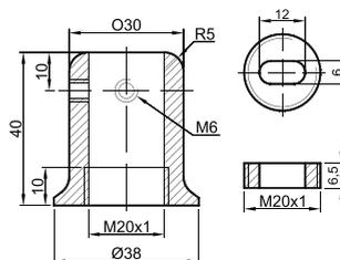
Применение: для трубы диаметром 19 мм
