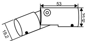
Применение: для трубы диаметром 19 мм
