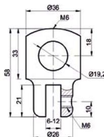
Применение: для трубы диаметром 19 мм
