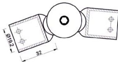
Применение: для трубы диаметром 19 мм
