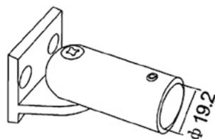
Применение: для трубы диаметром 19 мм
